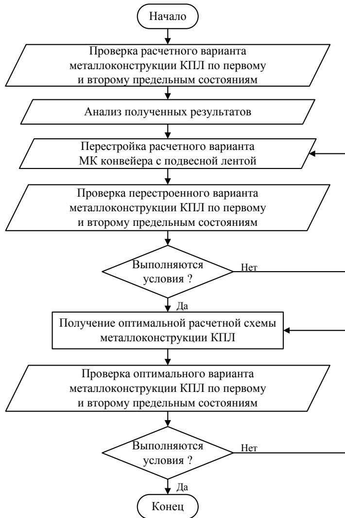
Рис. 4. Этапы оптимального проектирования металлоконструкции стационарного КПЛ
